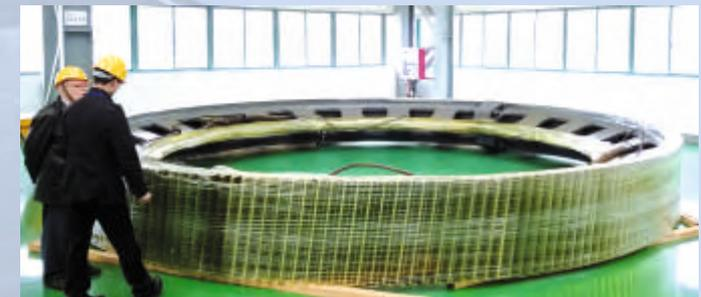
Zahnkranz aus Stahlguss (2-teilig gegossen) vergütet, bearbeitet, verzahnt
