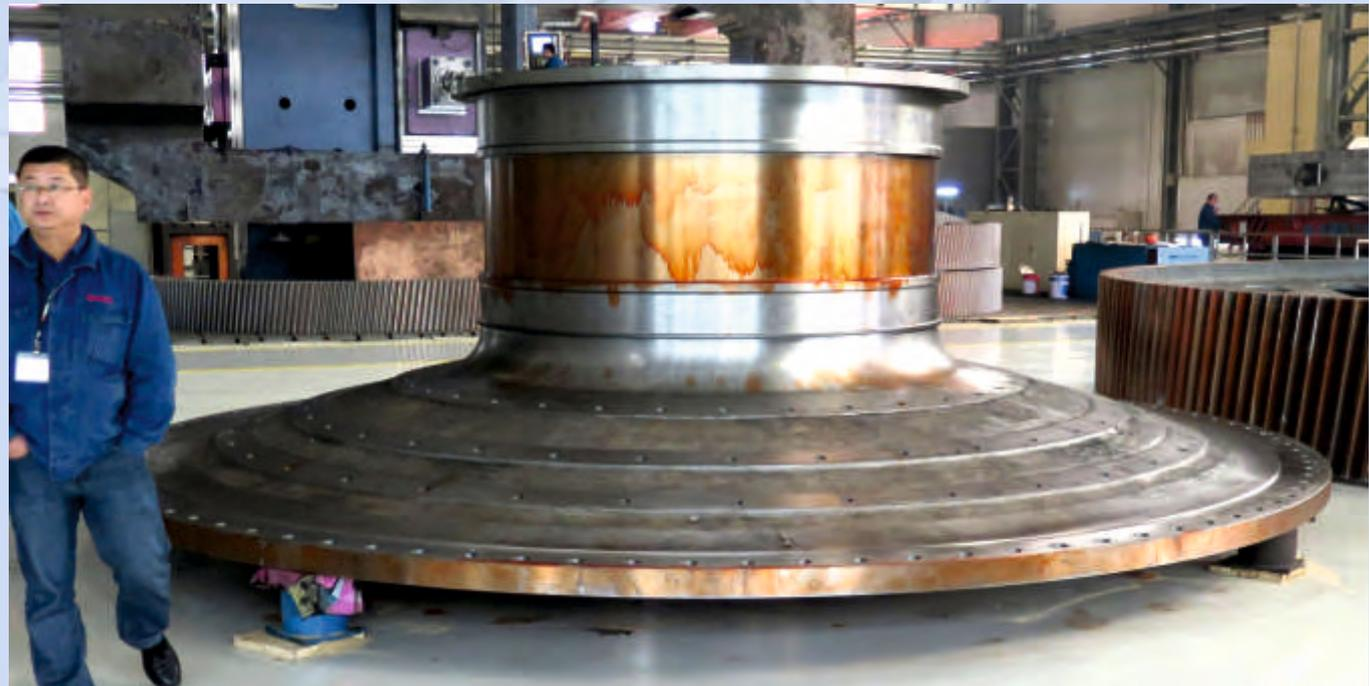
Zapfen für Zementtrommel, aus Stahlguss, wärmebehandelt, einbaufertig bearbeitet, bereit zur Endkontrolle.
