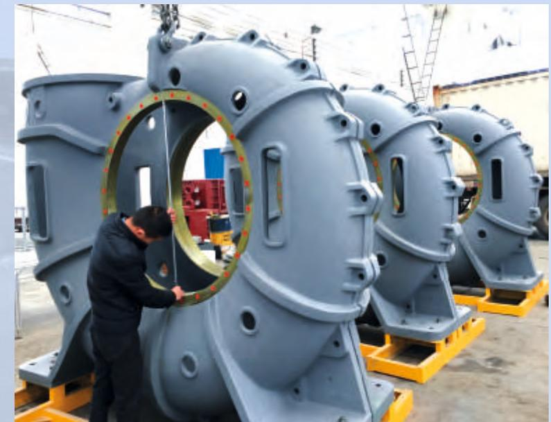
Getriebegehäuse aus Sphäroguss, vorbearbeitet.
