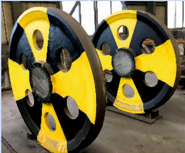
Kranlaufräder aus Stahlguss
