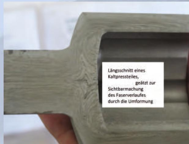
Faserverlauf eines Kaltformteiles.
