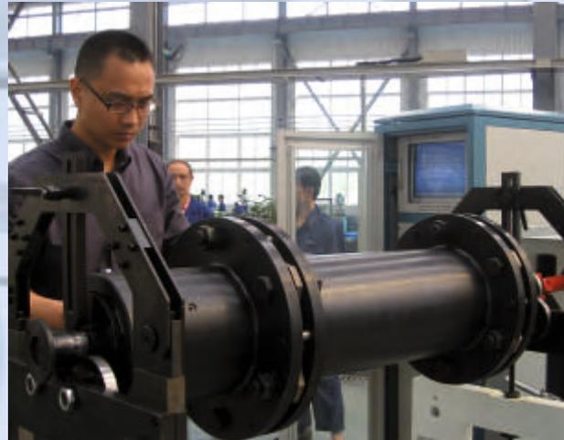
Herr Guo bei der Prüfung der Unwucht einer Pumpenkupplung.
