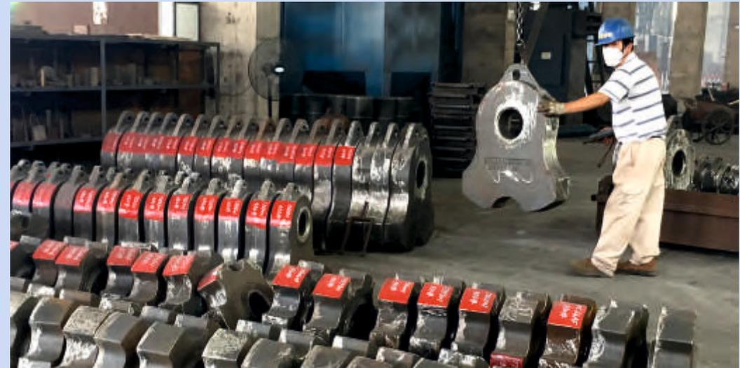
Schlaghämmer aus Hartmangan, gegossen, wärmebehandelt, gestrahlt und geputzt. Jedes geprüfte Bauteil wird eindeutig gekennzeichnet.
