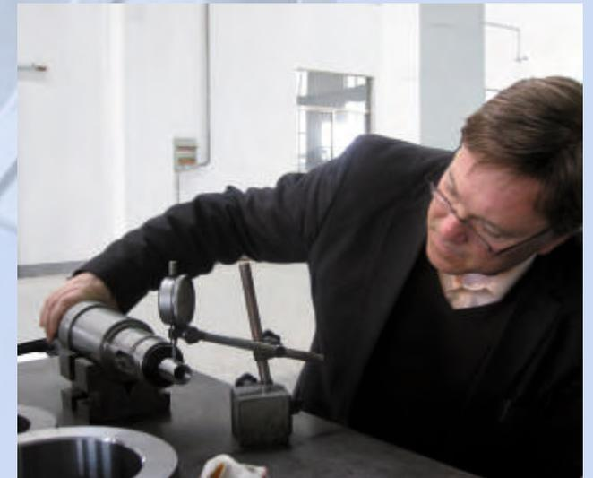
Prüfung der Rundlaufgenauigkeit.
