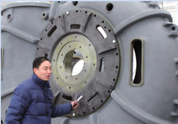
Herr Wang bei der Prüfung eines Pumpengehäuses aus Sphäroguss EN-GJS 450, grundiert. Er prüft auch die bereits montierten Verbindungsteile.
